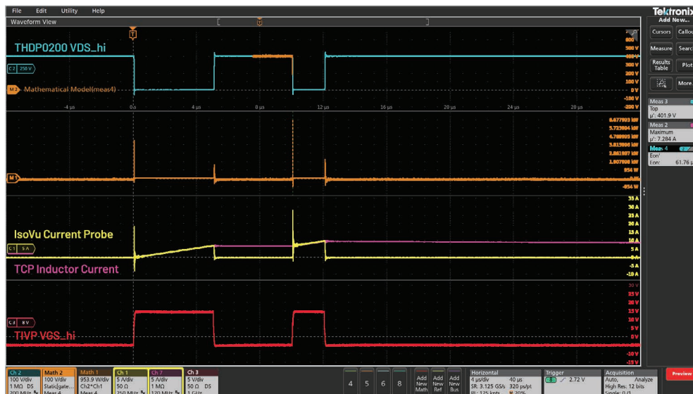
IsoVu電流プローブにより、リングングをクリアに観測
